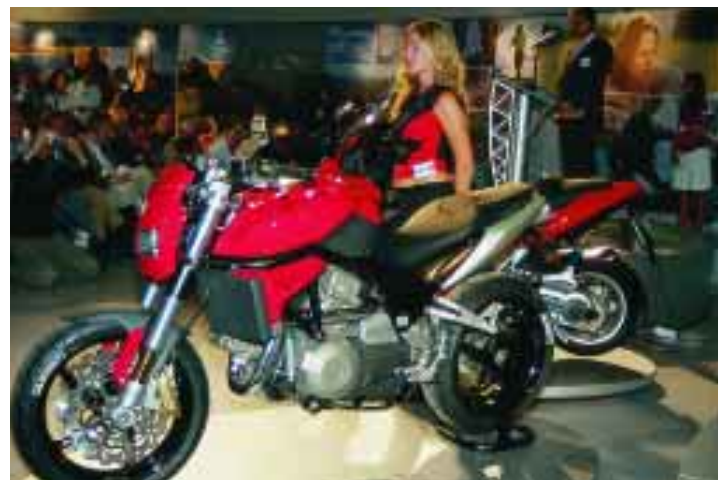
Gilera Ferro mit V2-Vierventil-Triebwerk
